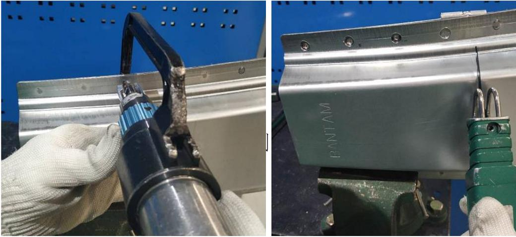
(1) 根据 D 板长度尺寸，割锯切割分离 A 板件。（如下图）
