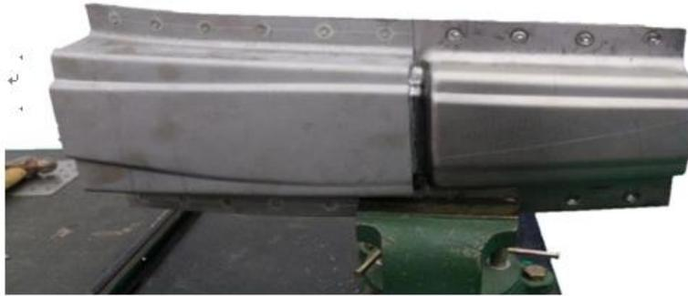
b) 根据 E 板件长度尺寸，切割分离 B 板件 (如下图)
