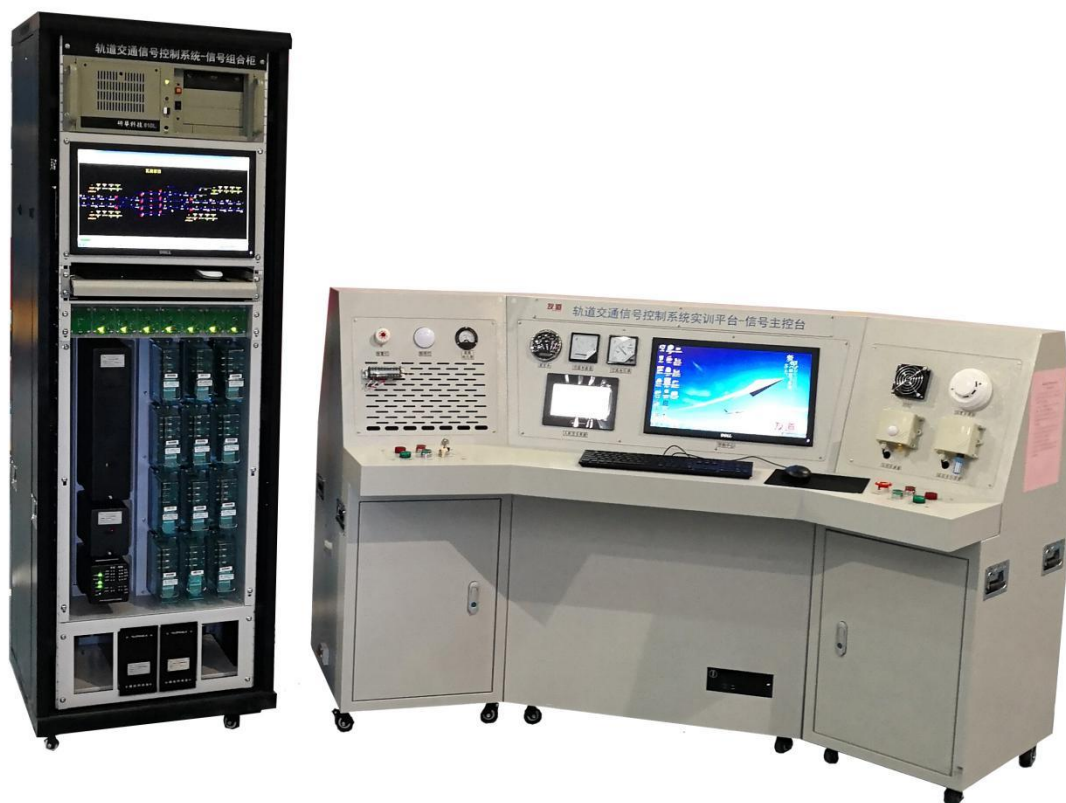
图2 轨道交通信号控制系统实训平台
