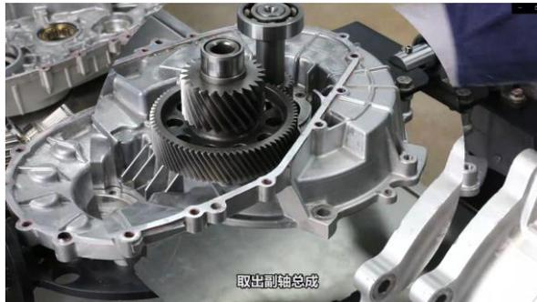
6.3 拧紧中间轴总成固定螺栓拧紧扭矩  $12\text{N} \cdot \text{m}$
