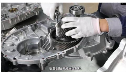
3.2 取出中间轴总成放置在齿轮组放置架上
