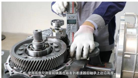
4、计算变速器轴总成安装间隙，并参照维修手册选用合适调整垫片厚度
