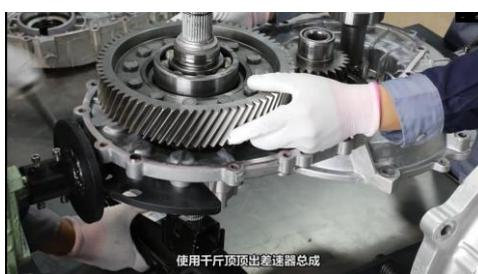
2.5 取出差速器轴总成，放置在齿轮组放置架上
