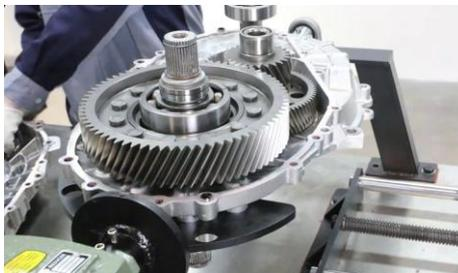
7.2 使用大号一字螺丝刀调整差速器轴固定盘，至固定盘螺杆从底部滑出
