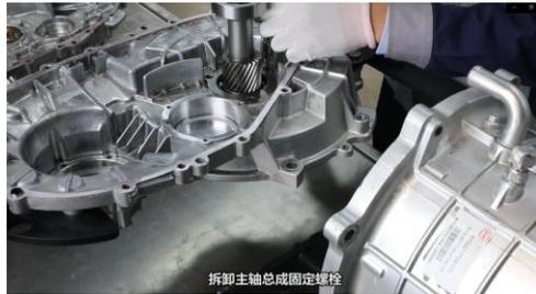
4.2 取出主轴总成放置在齿轮组放置架上
