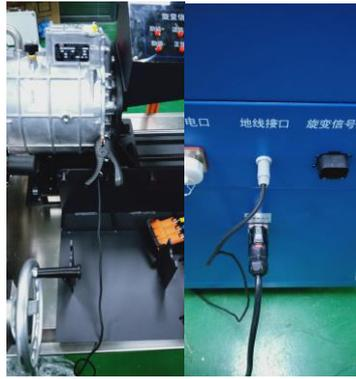
1.2 连接驱动能量供给平台与动力总成拆装实训台之间的三相电源线束
