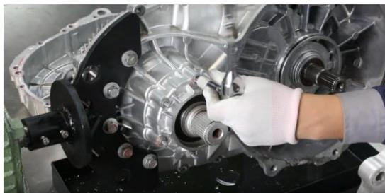
2.3 摇动翻转架摇柄，放平减速箱（齿轮组朝上）
