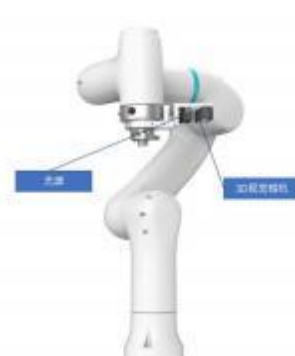
图 13 3D 视觉检测单元
